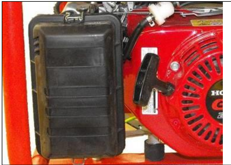
Obr. 4.7: Odstránenie vzduchového filtra
