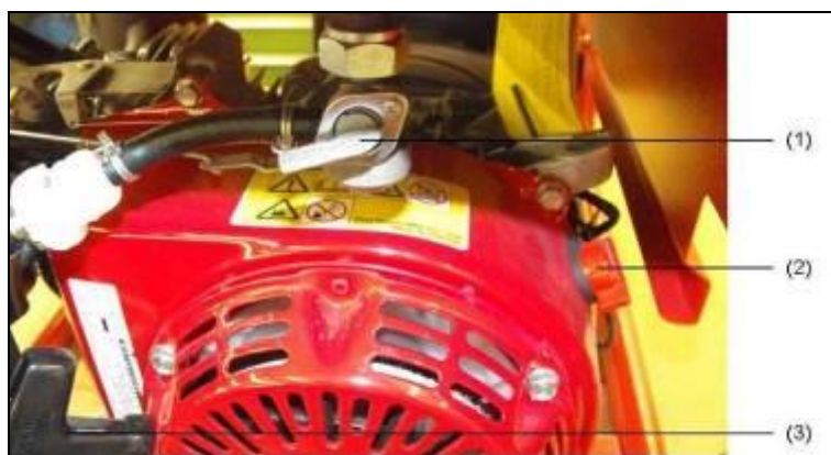
Obr. 4.1: Otvorenie/zatvorenie uzatváracieho kohúta paliva
