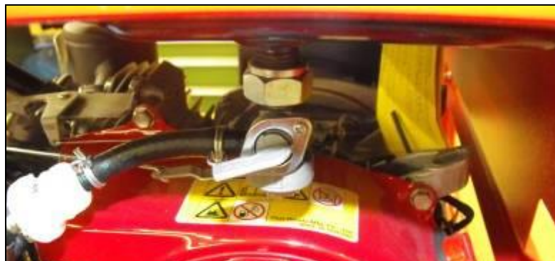
Obr. 4.5: Zatvorenie uzatváracieho kohúta paliva
