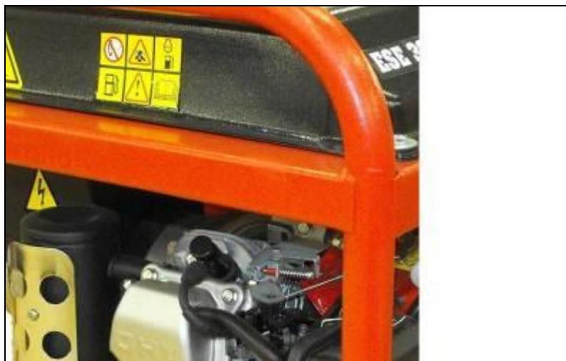
Obr. 4.6: Vytiahnutie konektora zapalovacej sviečky
