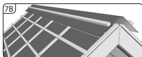
7. U neodvětraných střech membrána prochází přes hřeben za účelem zabezpečení těsnosti před sněhem a deštěm (7A). U odvětrávaných střech se střešní membrána musí ukončit 5 cm pod nejvyšším bodem hřebenu (7B). Vzniklý ventilační otvor je potřeba dodatečně překryt pásem membrány zajištěným kontralatěmi tak, aby přesahoval přes membránu min. 20 cm.
