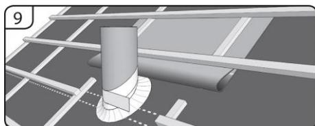
9. V případě menších prvků (např. Odvětrání šachet) membránu nafežte ve tvaru lichoběžníku a trvale připevněte k latím.
