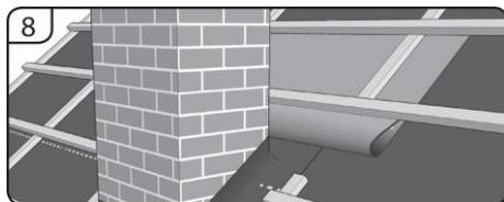
8. Pro prvky vystupující ze střechy (komíny, střešní okna) membránu nařízněte, vytáhněte ji a připevněte např. pomocí butylového pásku. Nad daným prvkem vytvořte okapový žlab z dostatečného kusu membrány. Horní konec vložte pod nejbližší pás membrány a spodní konec srolujte směrem nahoru a přibijte k latí nad překážkou. Spád ze žlabu vyvedte mimo překážku.
