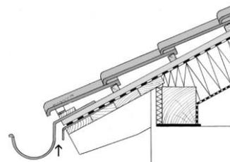
3. Membránu ukotvíme ke krovu pomocí nerezových hřebíků nebo sponkami, a to vždy v místech přesahu a nad spojením páskou. Kotvení do krokví provádějte nejlépe ve středu krokve, aby kontralat' s těsnicí páskou překryla kotvicí prvky.
